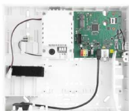
JA-103K Πίνακας ελέγχου συναγερμού JA-100+
